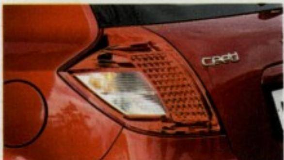
➊ Одна из бюджетных особенностей задней светотехники: обычная лампа накаливания, линза и дополнительный рассеиватель в стоп-сигналах имитируют фонарь со светодиодами.
