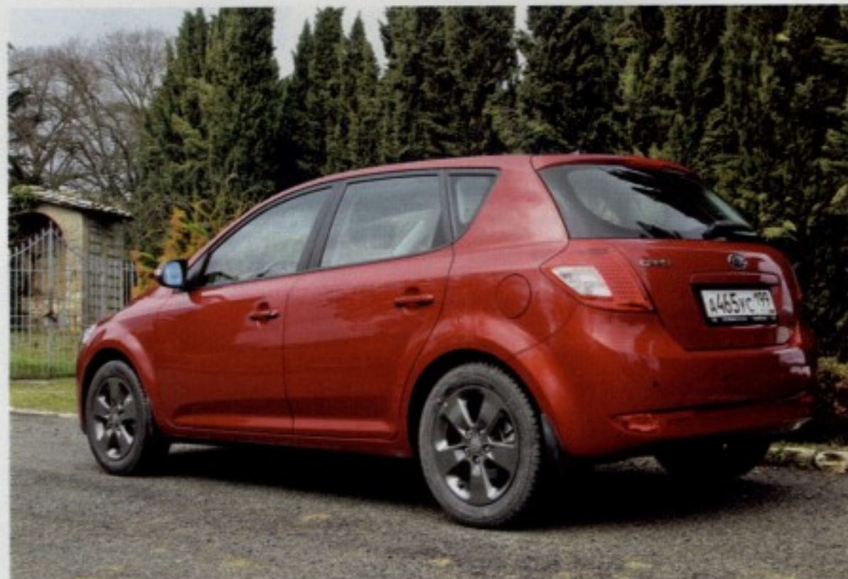
Модные фонари за счет нового рассеивателя создают иллюзию «светодиодности», хотя на самом деле в них стоят обычные лампы накаливания. Из видимых изменений у хэтчбека еще и новые легкосплавные колеса с увеличенной на полдюйма шириной обода
